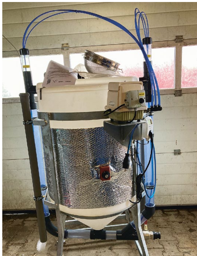
Machine voor het bereiden van compostthee. foto Carola van Ruiswijk
